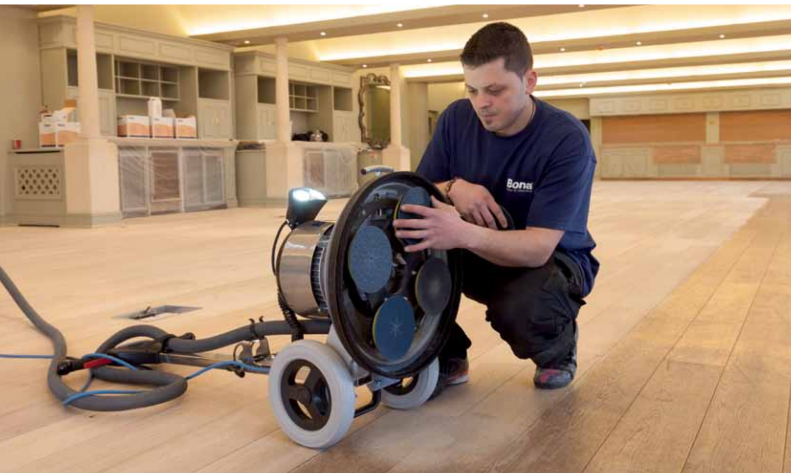
Bona 8300 Zirkonium Mix Schijven/Rollen/Banden Antistatisch en hittebestendig. Gereduceerde stofaccumulatie
